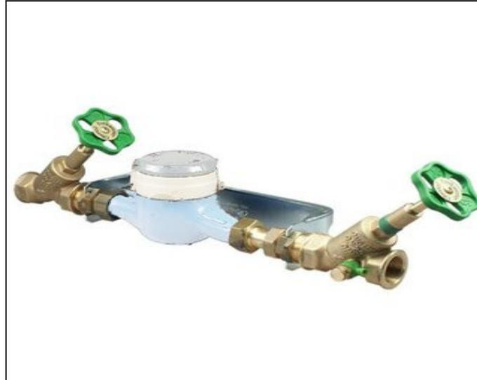
Der Wasserzählerbügel sorgt dafür, dass der Wasserzähler spannungsfrei montiert werden kann. Wasserzähler sind grundsätzlich spannungsfrei einzubauen (DIN 1988, Teil 2.9 ff.).
